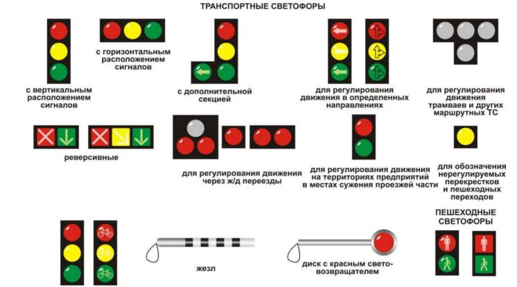
Светофор – техническое устройство, служащее для регулирования движения транспортных средств и пешеходов.
